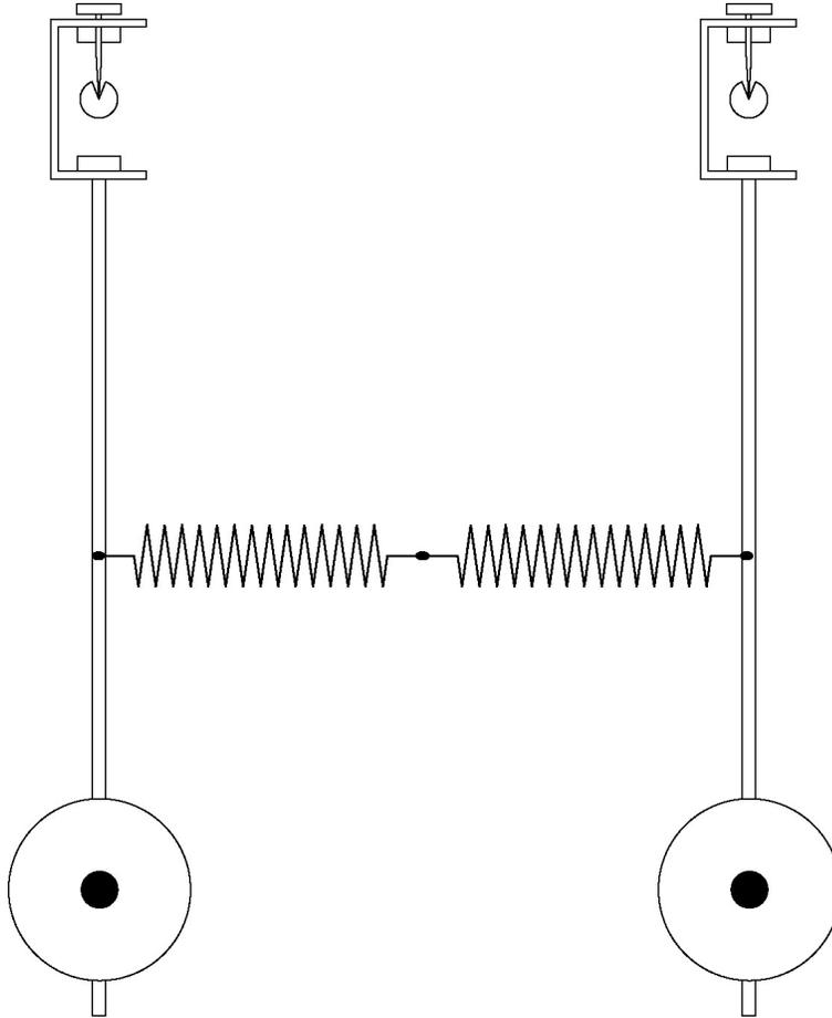
Abbildung 1.2: Aufbau des gekoppelten Pendels
